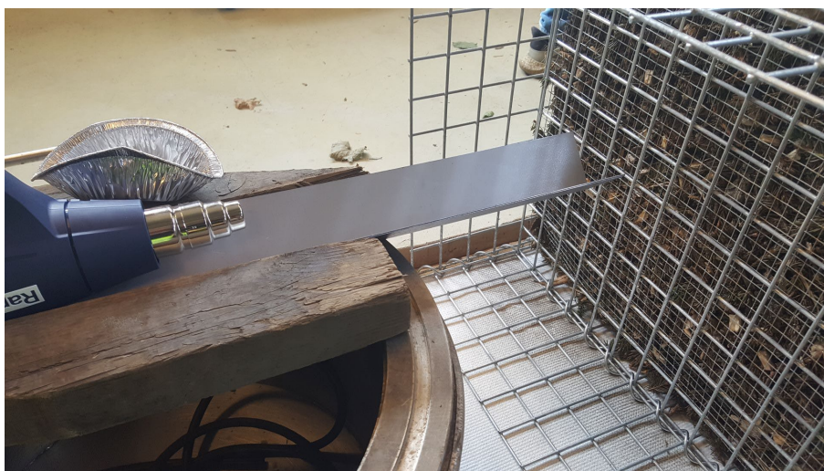
Figur 6 viser oppsettet med blåsepistol og renne som blåser tørket støv fra sedimenter av tunellvaskevann mot trevirket i miljøskjermen. Avstand fra rennekanten til treveggen var 10 cm.
