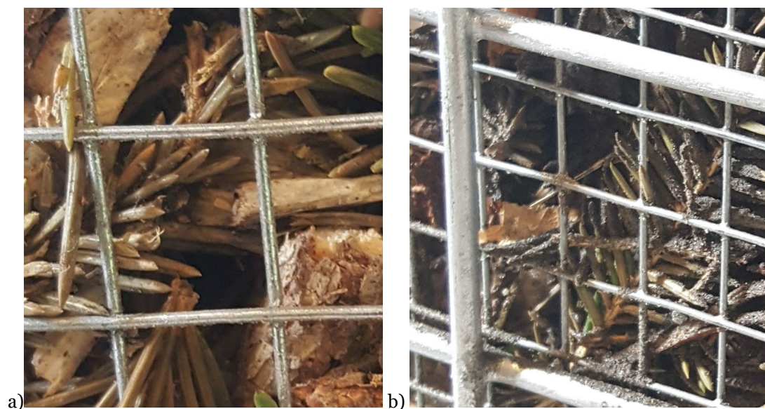
Figur 7 viser nærbilder av oppmalt hogstavfall fra gran med tørket støv fra sedimenter av tunellvaskevann som er blåst på miljøskjermen. Bildene viser at også at det er mer synlig støv på fuktet oppmalt hogstavfallet (b) der støvet ligger som en grå hinne på materialet enn på ikke fuktet overflater (a).
