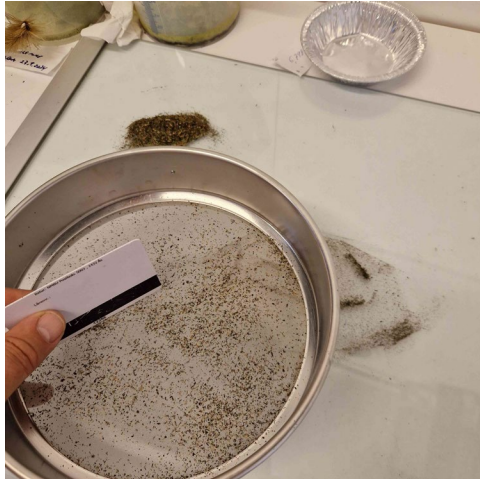
Figur 7 viser bilde av siktefraksjoner på en glassplate. Sikten var på 0,212 mm og fraksjonen 1-0,212 mm ligger igjen i sikten. På glassplaten er støv mindre enn 0,212 mm. Opp til venstre på bildet er en fraksjon > 1 mm.
