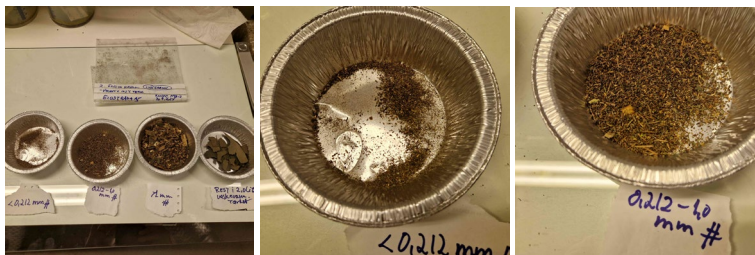
8.2: a) Prøve 2 Flis og krull. b) <0,212 mm c) 0,212-1,0 mm
