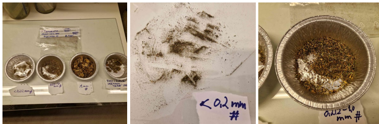
8.3: a) Prøve 3 Flis og krull m fiberduk b) <0,212 mm på glassplate c) 0,212-1,0 mm
