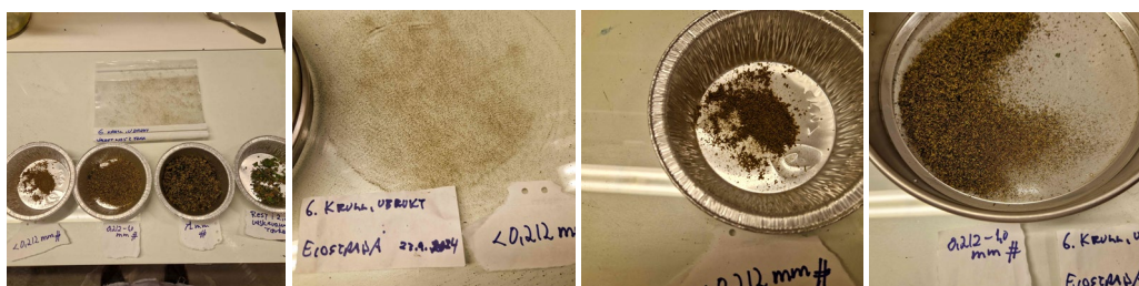
8.6: a) Prøve 6 Ubrukt krull b) <0,212 mm på glassplate c) <0,212 mm d) 0,212-1,0 mm
