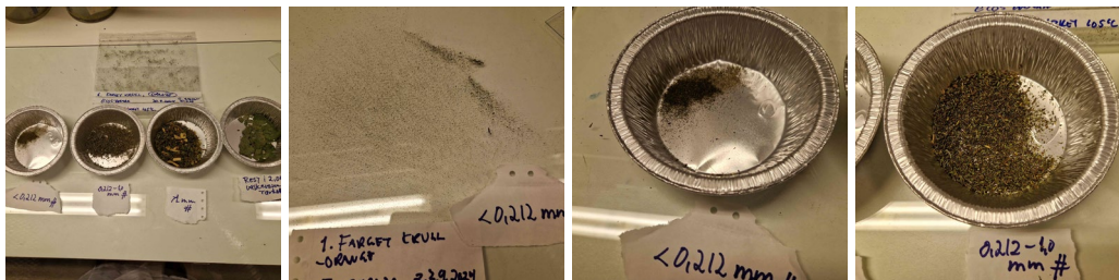
8.1: a) Prøve 1 farget krull. b) <0,212 mm på glassplate c) <0,212 mm d) 0,212-1,0 mm
