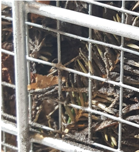
Figur 11 viser fyllmaterialer av grot i Ecostrade miljøskjermer eksponert av tunelveistøv. Bildet hentet fra: R. Aasen, 2022: Ecostrada – Capturing roadside pollution. Forprosjekt for konseptutprøving av Miljøskjermer av hogstaufall fra gran med ISSN 2464-1162 og saksnummer 22/00303 i NIBIO.
